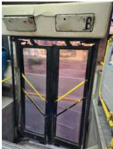
Figura 1. Interior de vehículo - Puerta en mal estado / ruta 8212
