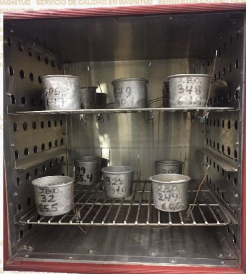
Foto de distribución de la carga y termopares dentro de camara del Horno.
