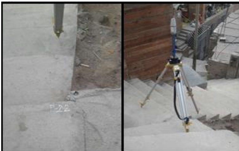
Figura N° 11: Ubicación y marca del Punto de Control.
