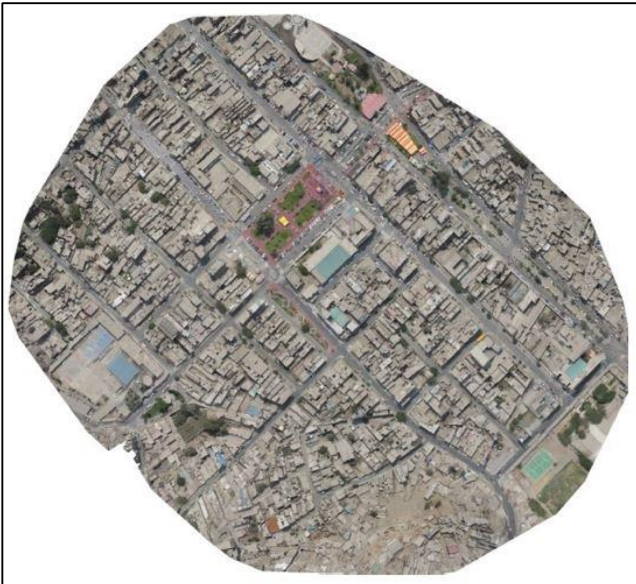
Figura N° 15: Vista Previa de la Ortofoto Fuente: Reporte del procesamiento del proyecto en Pix4D.
