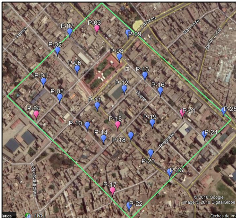
Figura N° 30: Distribución de los Puntos de Control (05) y Puntos de Chequeo (20)
