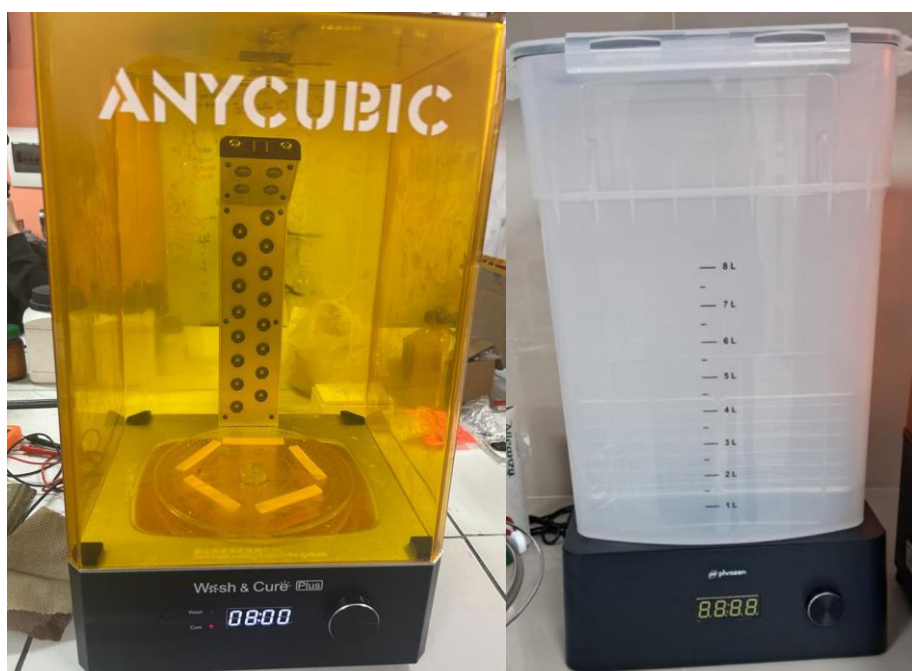
Fig 8. Camara de curado y lavado de los bloques impresos
