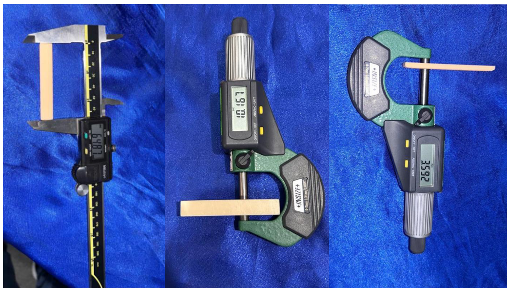
Fig 9. Medición de los bloques impresos
