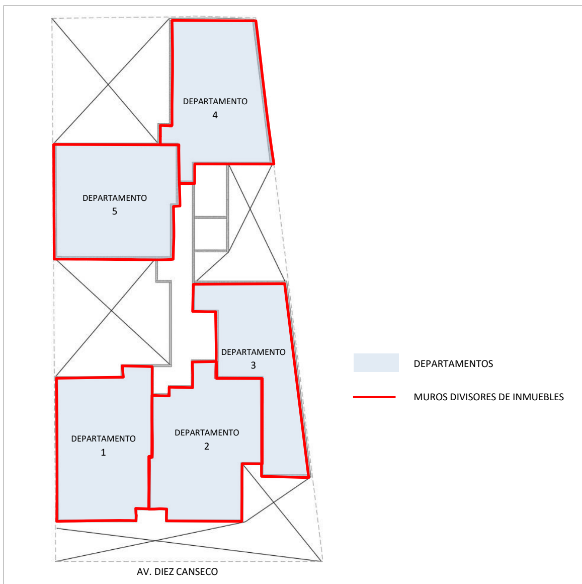
Figura 14. Definición de departamentos con muros de tabiquería
