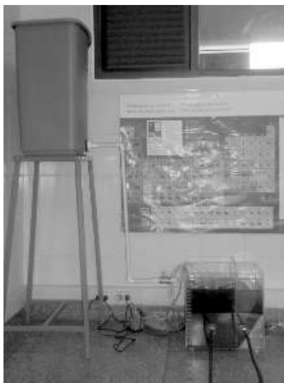
Figura 1.1.b: Montaje del Sistema de Laboratorio de Lodos Activados.
