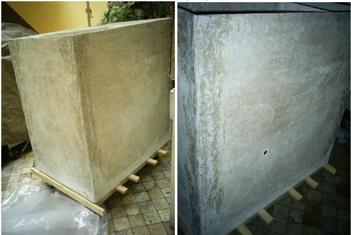
Figura 3.2.1.1.b. Tanque fabricado en fibra de vidrio del Sistema de Tratamiento Compacto de Lodos Activados Secuenciales (SBR).
