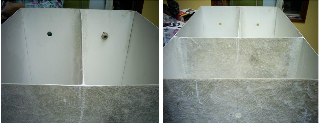
Figura 3.2.1.1.c. Otras dos vistas del tanque fabricado en fibra de vidrio.
