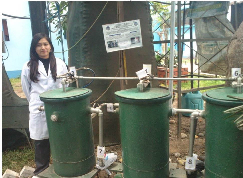
Figura 1.1.e: Planta Piloto de Lodos Activados (SBR), de la FIARN - UNAC
