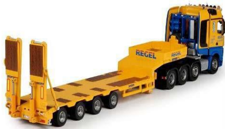
Camión tracto – cama baja
