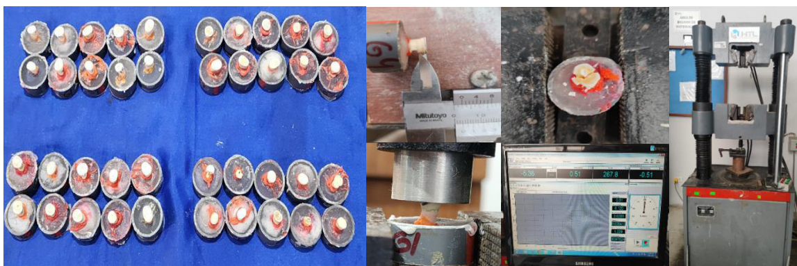
Imagen 5: Confección de bases acrílicas y prueba de ensayo de resistencia a la compresión en máquina de ensayo universal.
