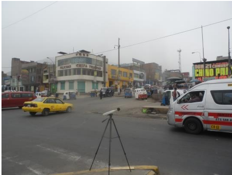
Figura 19. Monitoreo de ruido ambiental entre las avenidas Túpac Amaru y Manuel Prado
