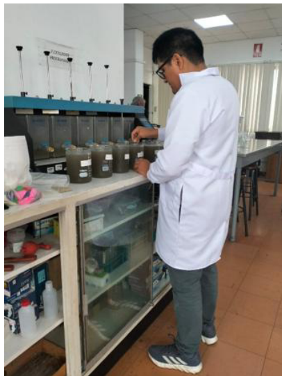
Aplicación de coagulantes en muestras de agua residual
