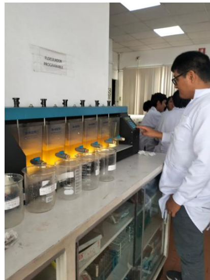
Aplicación de coagulantes en muestras de agua residual
