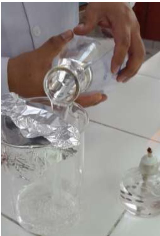
Agregando el medio liquido esterilizado
