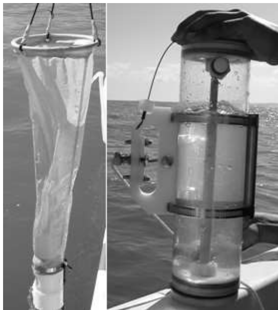
Red de fitoplancton y botella para colecta de plancton
