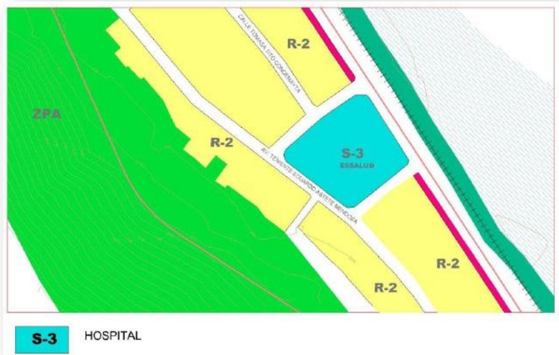
Figura 23. Zonificación del terreno en proyecto.
