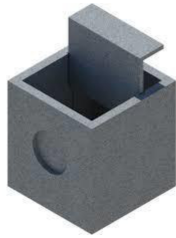
Cámara de Recolección de Aguas Crudas
