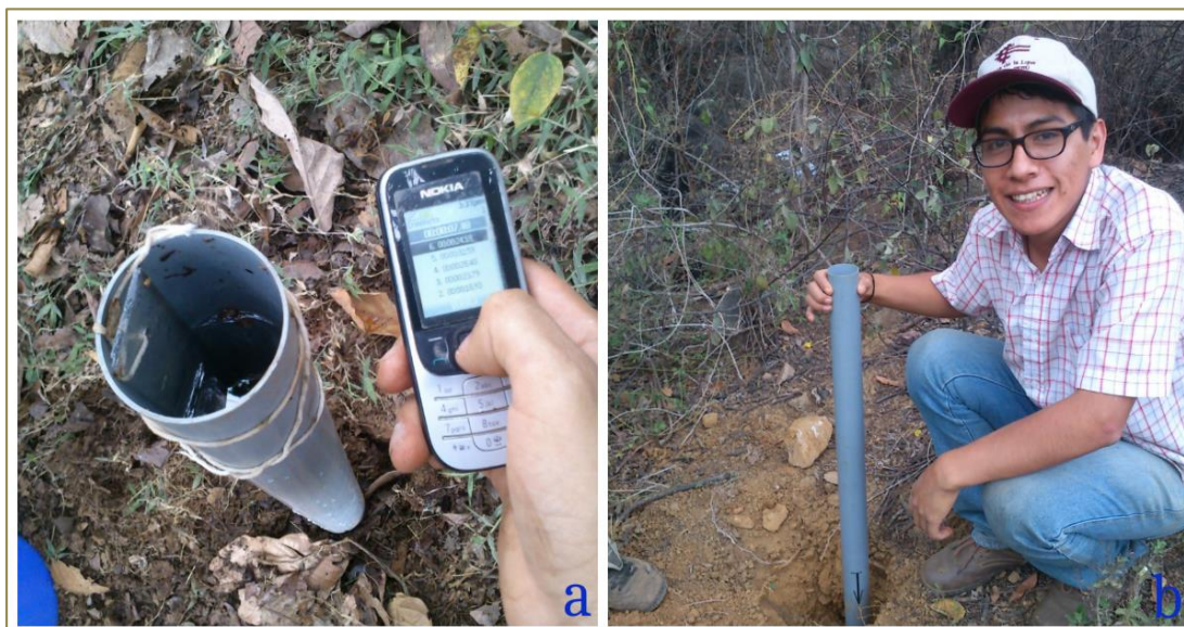
Fotografía 03: Pruebas de permeabilidad usando el método del tubo. (a) realizada en la localidad de San Antonio (1176 msnm), textura franca arenosa arcillosa de permeabilidad moderada. (b) realizada en la localidad de Loma Larga (574), textura franca arcillosa de permeabilidad lenta a moderada.
