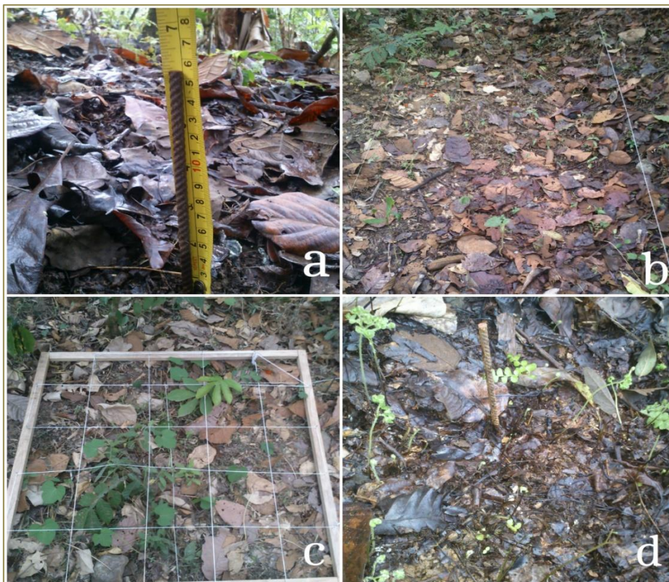
Fotografía 04: Evaluaciones realizadas en parcelas de varillas de erosión en la localidad de Palambla: (a) medición de varillas; (b) establecimiento de varillas en parcelas de 1.4 m x 3.2 m; (c) medición de la cobertura vegetal mediante el método del cuadrante y (d) evaluación de fragmentos de roca posterior a un evento lluvioso.
