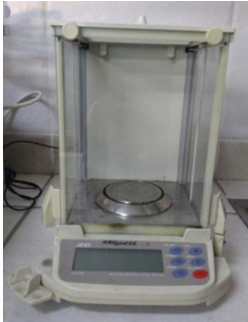
Figura 5B: Balanza AND modelo gr-2000, usada para el pesado de las sales y peces
