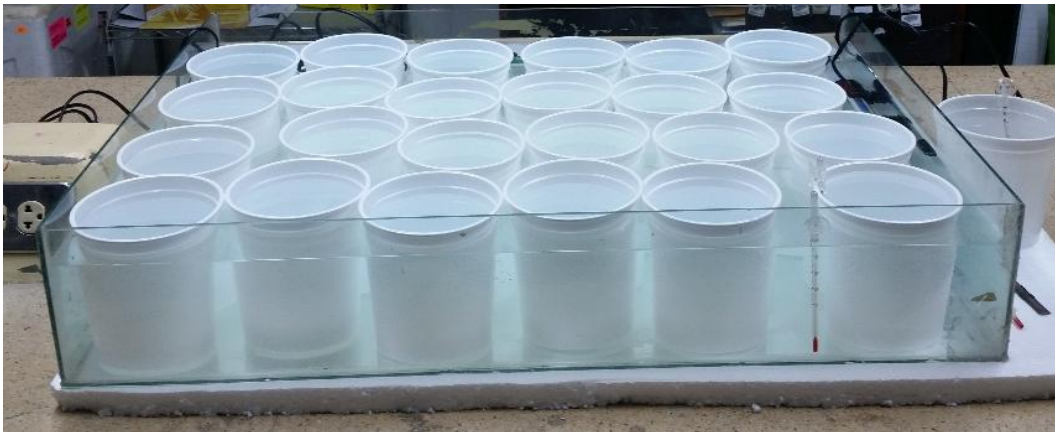
Figura 6B: Vista de ensayo definitivo para cadmio, cinco concentraciones y un blanco, cada uno con cuatro réplicas
