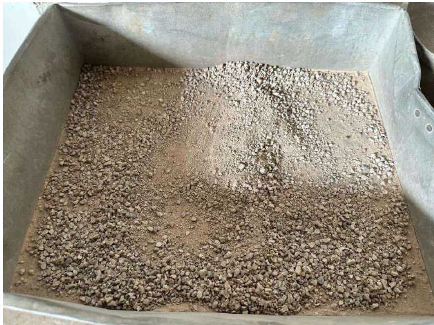
Imagen 12: Selección de material para análisis granulométrico
