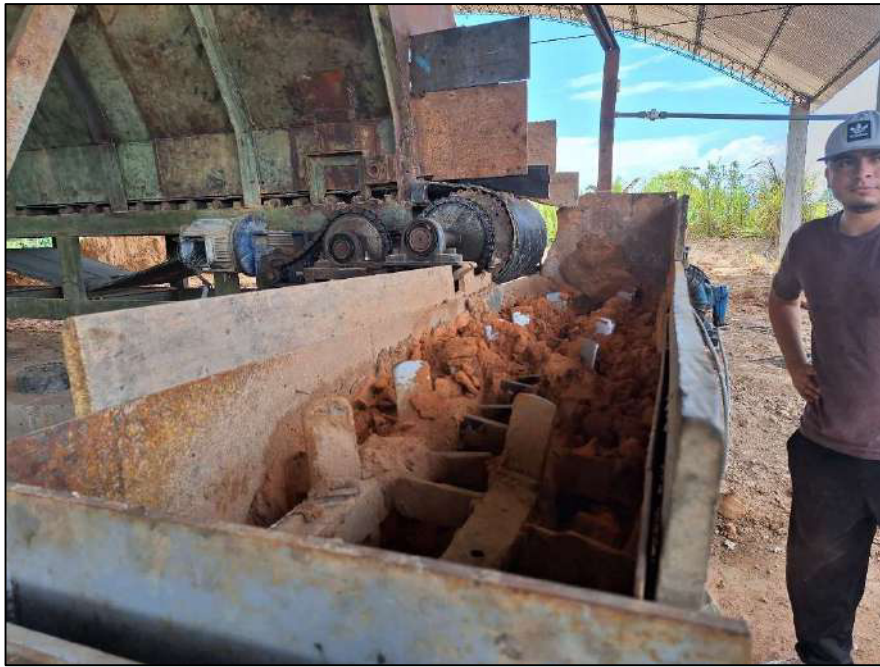
Imagen 07: Proceso de mezclado de material reciclado de construcción con la arcilla
