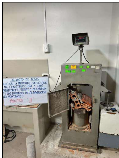
Imagen 16: Prisma de ladrillos sometidos a prueba de compresión
