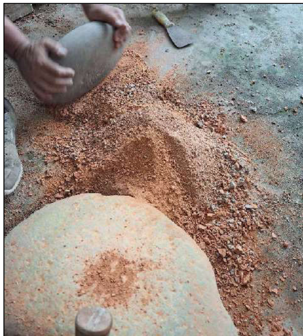
Imagen 02: Pulverización manual de material reciclado de construcción
