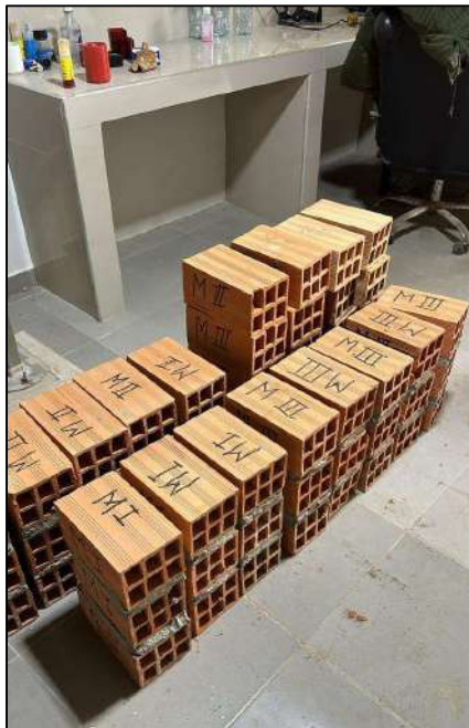
Imagen 14: Ladrillos antes de ser sujetos a las pruebas de resistencia
