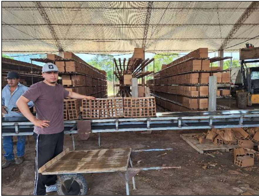
Imagen 11: Ladrillos entrando al proceso de cocción
