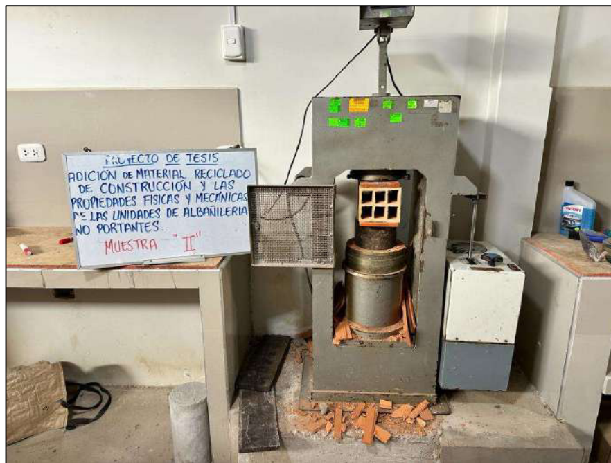
Imagen 15: Unidad de albañilería sometida a prueba de compresión
