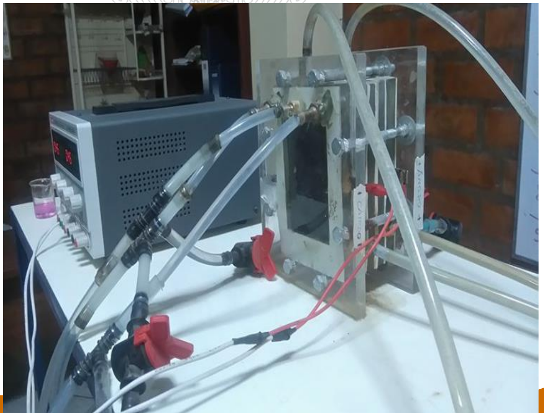
Figura N° 3.2: Diagrama de la celda electrodiálisis bipolar
