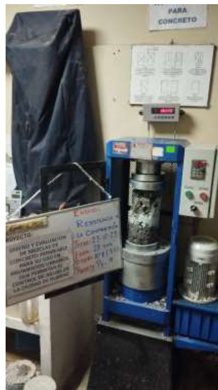
Rotura de probetas de concreto para verificar la resistencia a la compresión.
