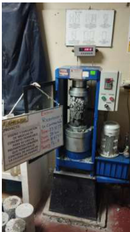
Rotura de probetas de concreto para verificar la resistencia a la compresión.
