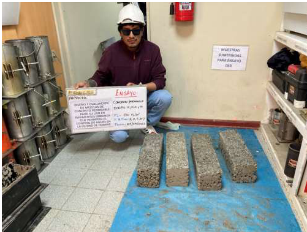
Vigas de concreto poroso en estado endurecido.
