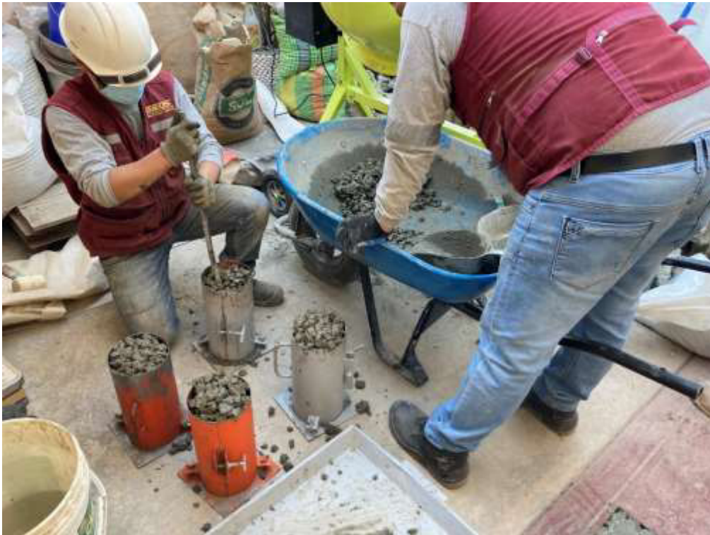
Vertido y chuzado de concreto permeable en estado fresco.
