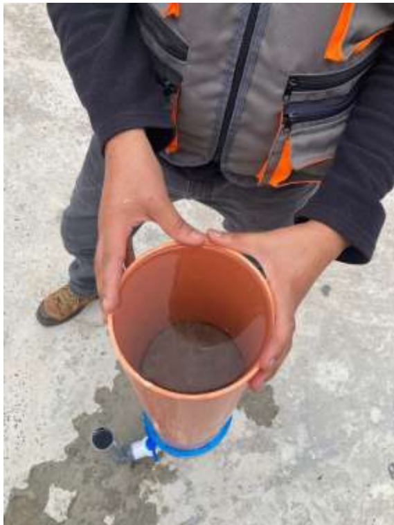
Vertido de agua en la tubería principal luego de la colocación de probeta en la misma.
