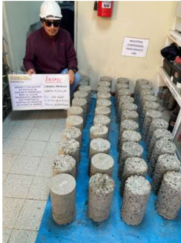
Probetas de concreto poroso en estado endurecido según diseño.
