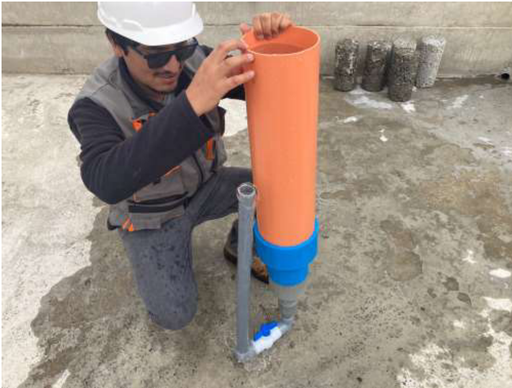
Abertura de la válvula para determinar la capacidad de infiltración con el uso del permeámetro de carga variable.
