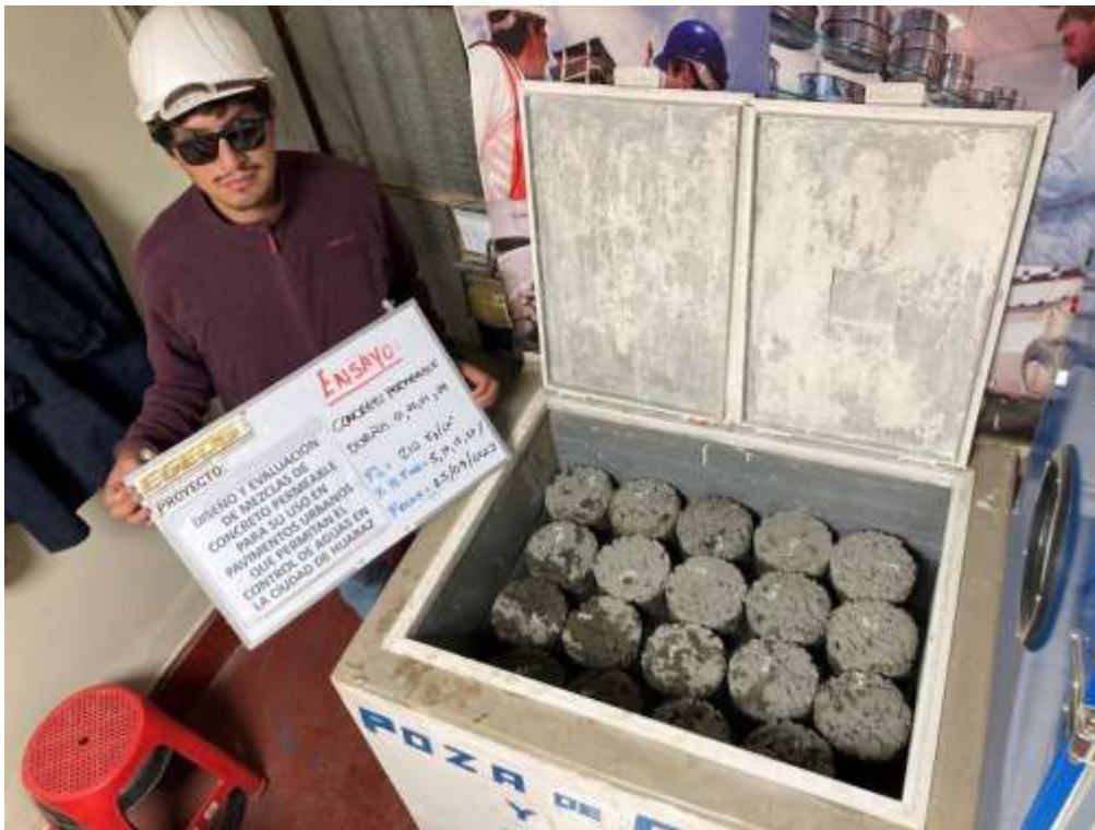
Colocación de probetas de concreto poroso en poza de curado.
