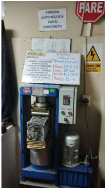
Rotura de vigas de concreto para verificar la tolerancia a la flexión.
