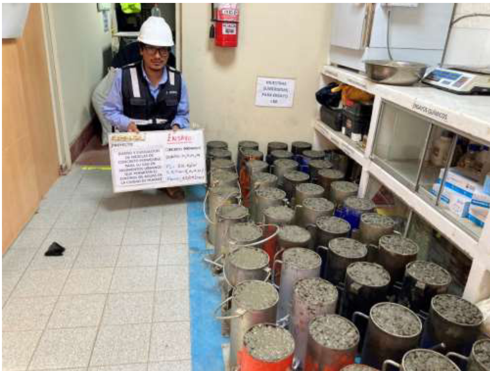
Probetas de concreto permeable en estado fresco según diseño.
