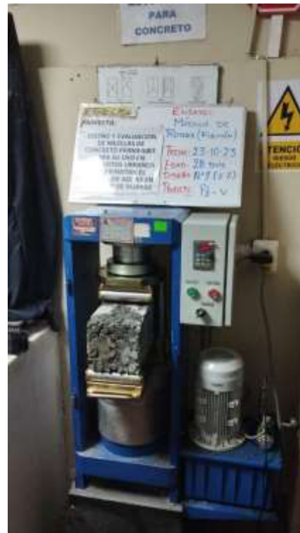
Rotura de vigas de concreto para verificar la tolerancia a la flexión.
