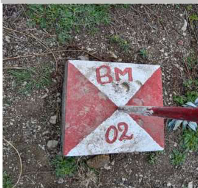
BM-02 UBICADO EN BLOQUE DE CONCRETO AL INTERIOR DEL TERRENO DE LA INSTITUCION
