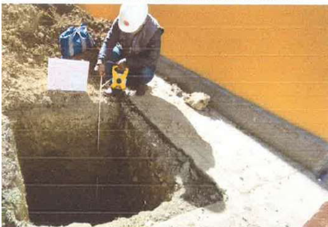
FOTO N° 01: Se muestra la excavación de la calicata C-01
