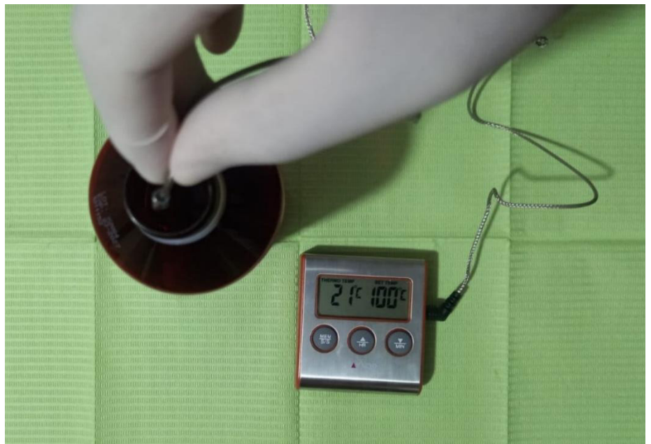
Medición de la temperatura de la clorhexidina utilizando un termómetro de sonda con cable (Taylor, USA) previo al inicio de las perforaciones.
