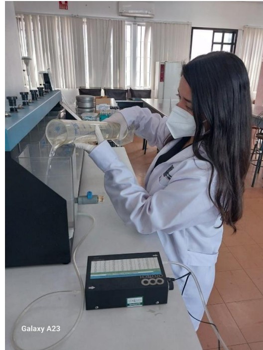
Llenado de muestras en las jarras del floculador
