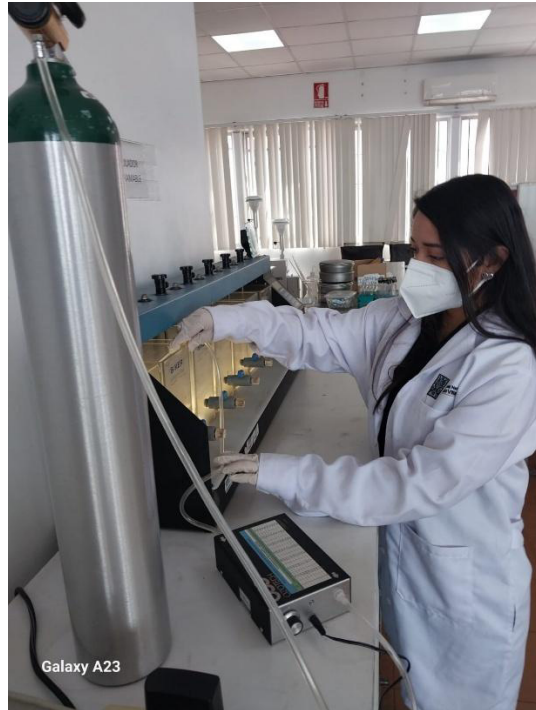
Inyección de Ozono en las jarras de floculación
