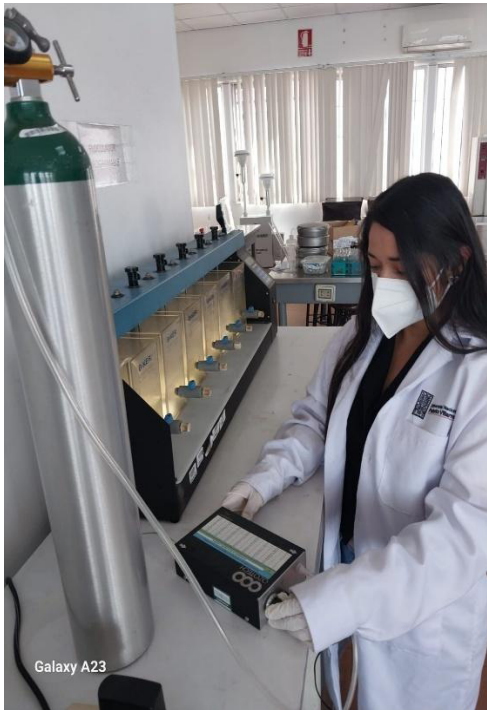
Ajuste de los niveles y concentración de ozono
