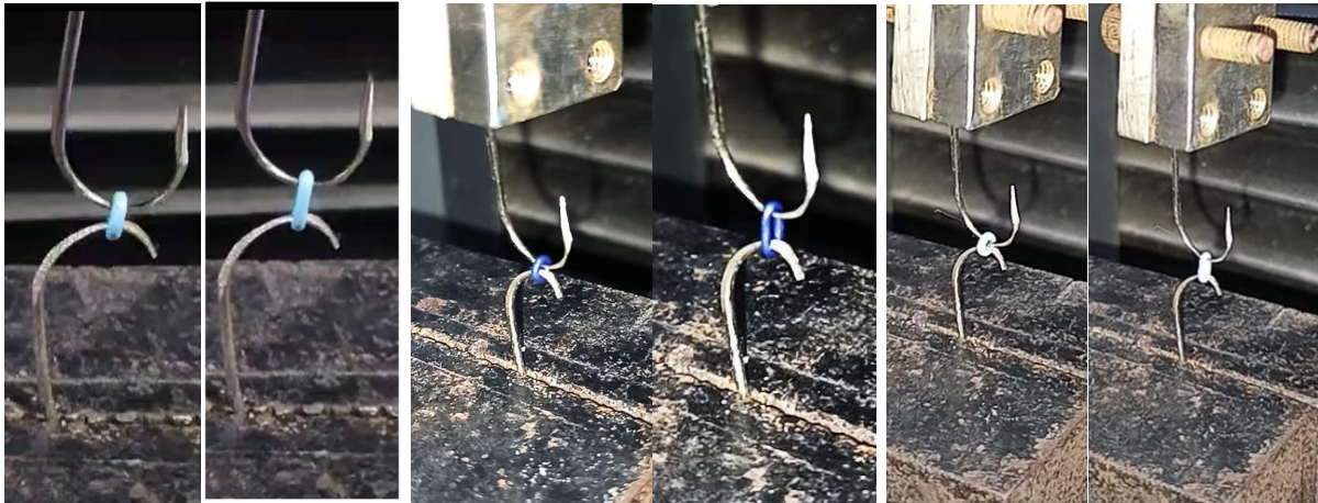
Imagen 9: Prueba de tracción antes del envejecimiento de los módulos elastoméricos Rocky Mountain Orthodontics®, American Orthodontics®, y Morelli® respectivamente.
