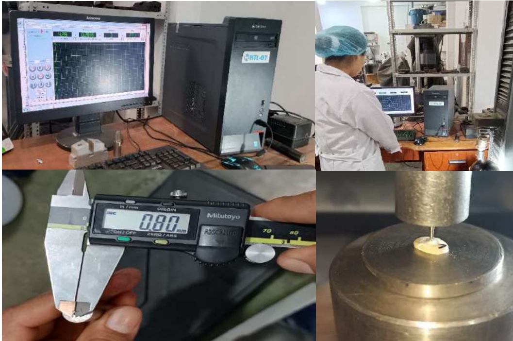
Imagen 8: El vástago se midió con el pie de rey. Luego los discos pasaron por la máquina de ensayo universal y se realizó la prueba de push-out
