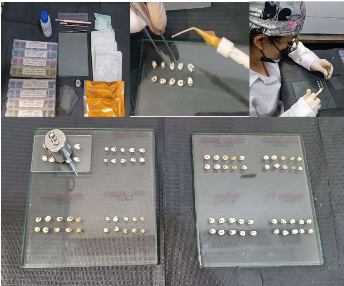
Imagen 5: Se llevaron las raíces dentales al laboratorio HTL y se cortaron en discos de 1mm+/- con una máquina de corte adaptada Dremel F013300050, luego se midieron los discos con el pie de rey y se clasificaron en ocho grupos de 10 discos cada una.
