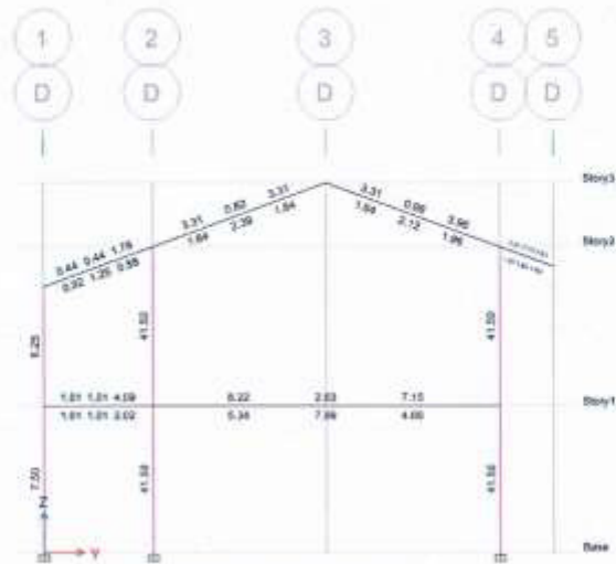
Vista en Elevación del acero requerido (cm 2 ) – Eje D
