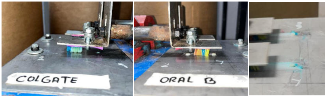
Imagen 12: Simulación de cepillado para 20 muestras de giomero (Riva Light Cure TM ), 10 con cepillo Colgate kids y 10 con cepillo Oral-B kids. Cada uno con su respectiva pasta dental
