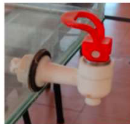
Colocación de las llaves de salida a los humedales.
