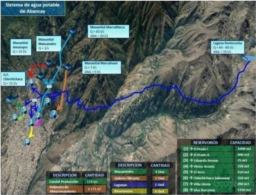
Fuente: Visita técnica efectuada a la EPS EMUSAP ABANCAY S.A.C. Elaboración: Dirección de Regulación Tarifaria (DRT) – SUNASS
