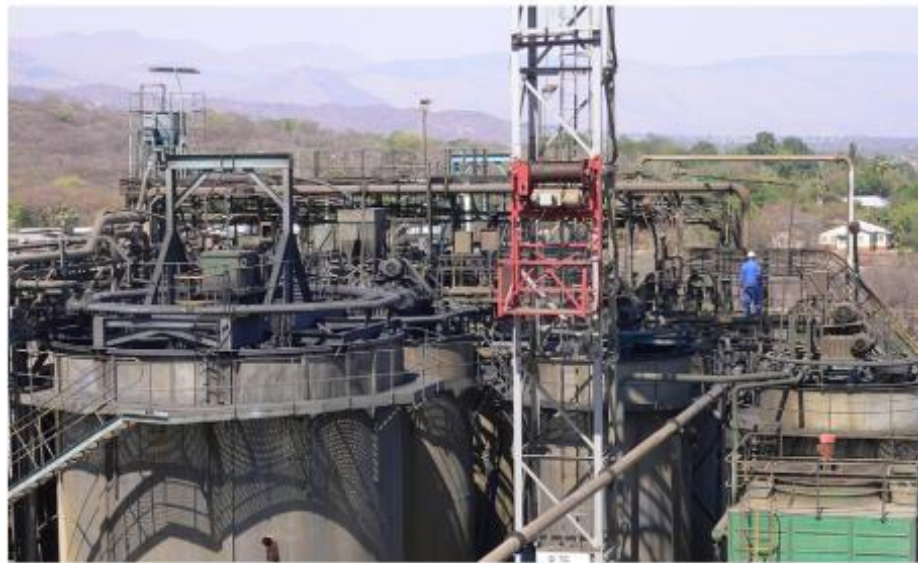
Figura 2. Proceso BIOX® para biooxidación de oro refractario concentrado en la mina Fairview Gold, Sudafrica. Figura adaptada de Kaksonen et al, 2014 .
