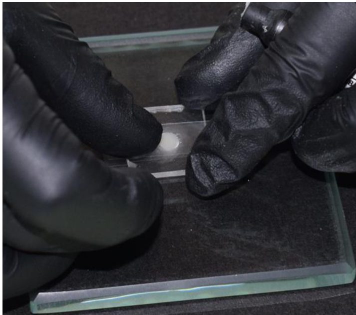
Compactación de resina compuesta sobre las platinas de acetato previa colocación de cinta celuloide en la base y luego en la cara superior del espécimen
