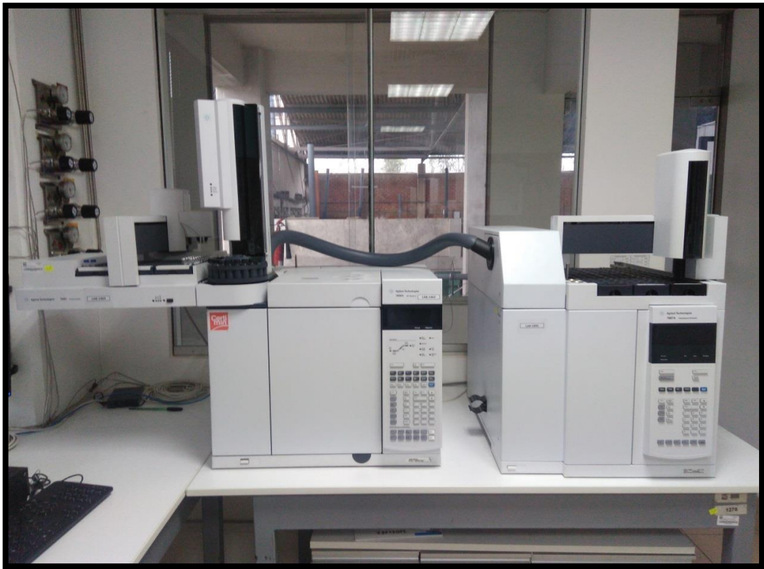
Fig. 32 Cromatografo de gases acoplado al automuestreador headspace
