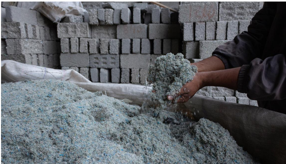
Ladrillo de plástico reciclado
