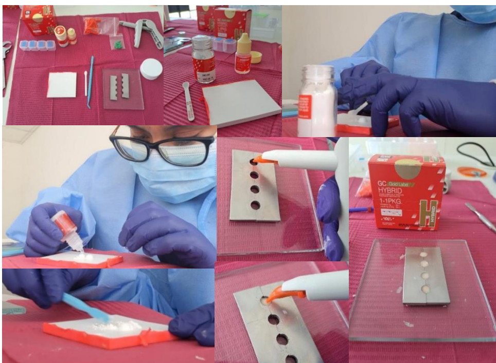
Imagen 3: Elaboración de 37 muestras de ionómero Gold Label Hybrid™ A2.
