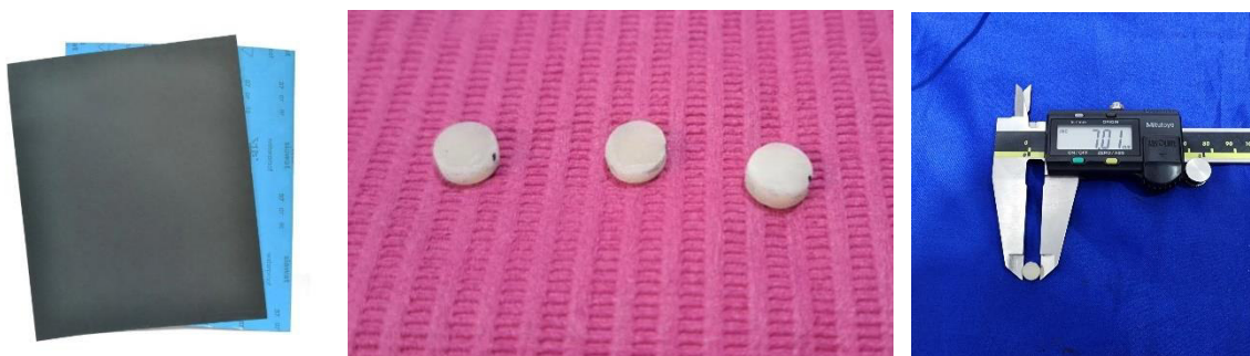
Imagen 5: Pulido de las muestras con lija de agua de 1000 con 7 mm de diámetro x 2.5mm de espesor.
