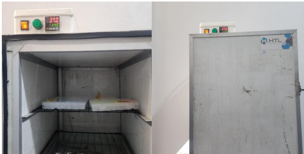
Imagen 8: Incubación de las muestras con agua destilada por 24 horas a temperatura de 37 grados.
