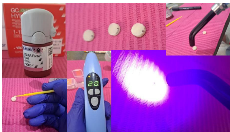
Imagen 7: Colocación del Equia Forte® Coat en las 37 muestras de ionómero Gold Label Hybrid™ A2 y 37 alkasite Cention N™ marcando con un plumón indeleble la cara del disco donde se coloca el barniz, fotocurando con Lámpara LED D-Woodpecker 20 sg.
