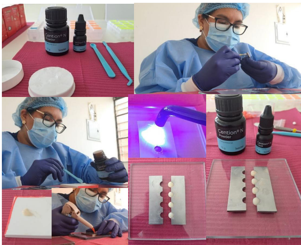
Imagen 4: Elaboración de 37 muestras de alcasite (Cention N™).
