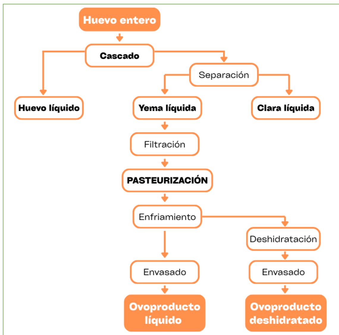
Anexo A: Flujograma de procesamiento de los Ovoproductos.
