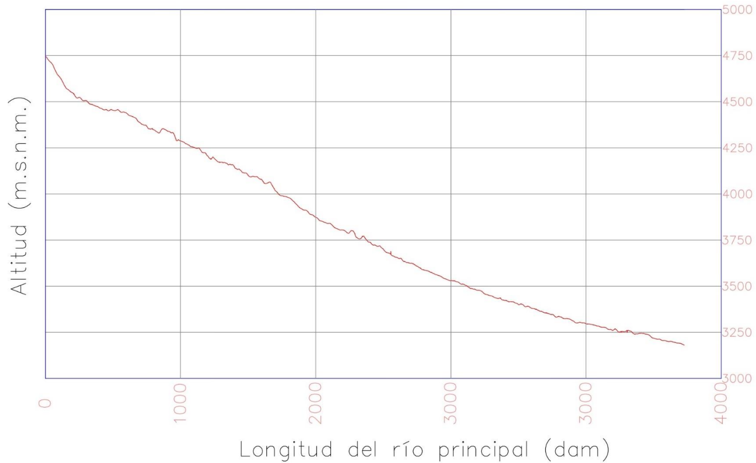
Figura 15. Perfil longitudinal del río principal
