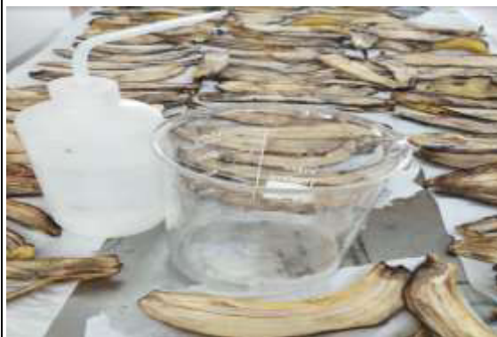
Lavado de la cáscara de plátano: Limpieza del bioadsorbente con agua destilada para eliminar impurezas antes del proceso de secado.
