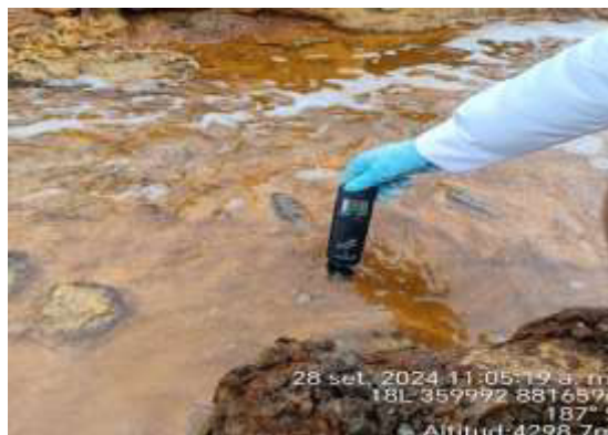
Medición de parámetros fisicoquímicos: Registro in situ de pH, temperatura y conductividad del agua mediante equipo multiparámetro.
