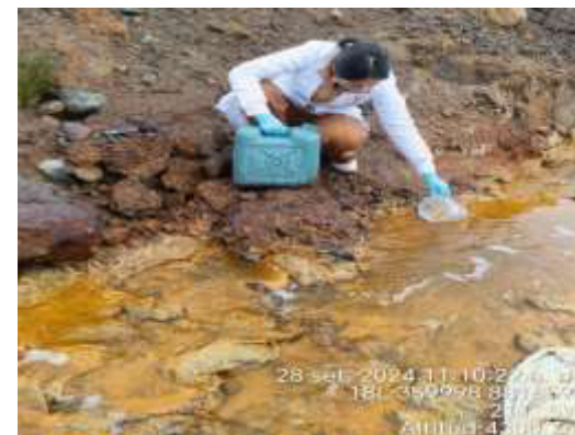
Recolección de muestras: Captura y almacenamiento de muestras de agua ácida en contenedores rotulados, siguiendo el protocolo de muestreo.
