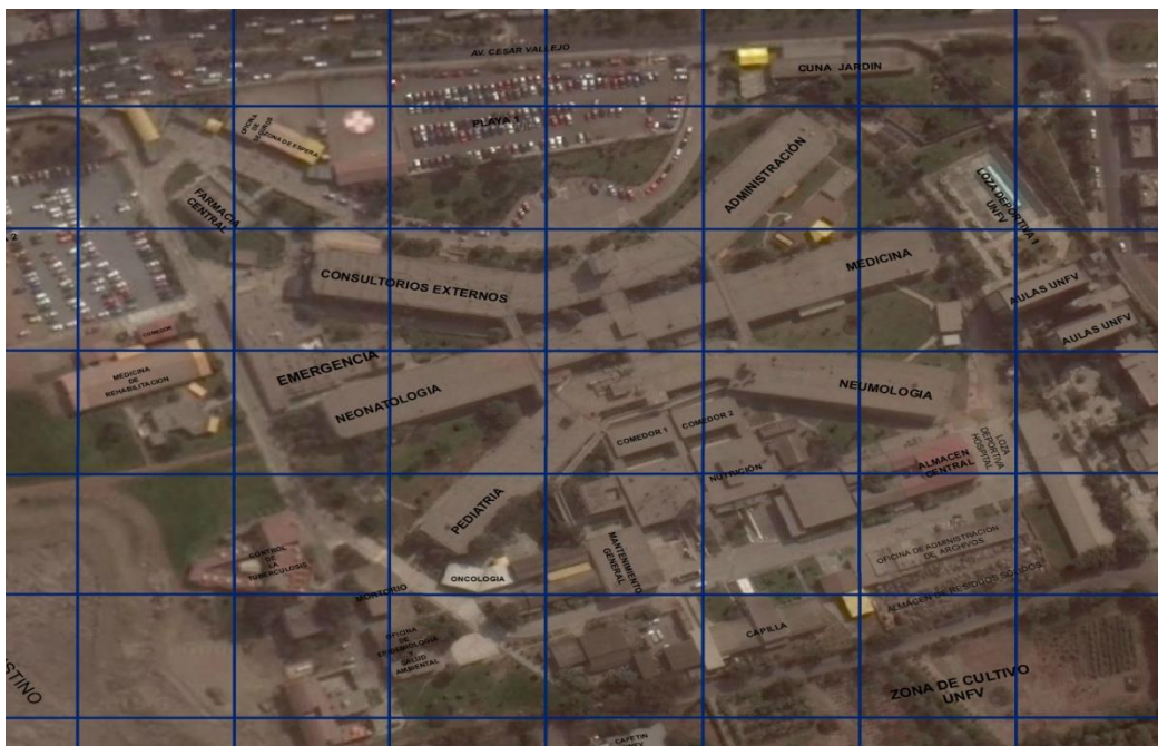
Figura N° 6: Método de cuadrícula o rejilla para la distribución espacial de los puntos de medición.
