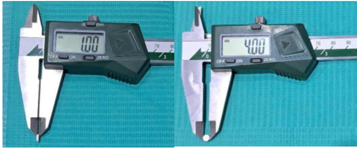
Imagen 5: Corroborando las medidas con ayuda del Pie de rey digital MITOTUYO
