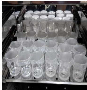
Imagen 6: Muestras en vaso Bicker con 10ml de agua desionizada
