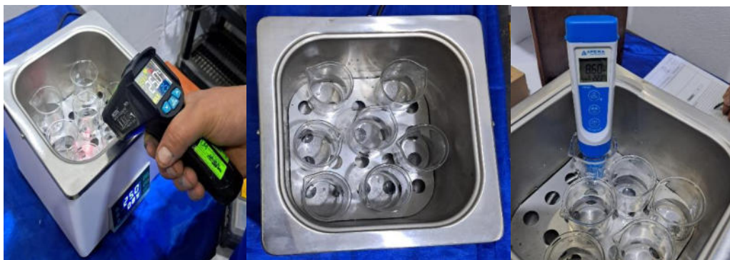
Imagen 7: Medición de pH con pHmetro PH60 pH Tester-Apera ®Instruments
