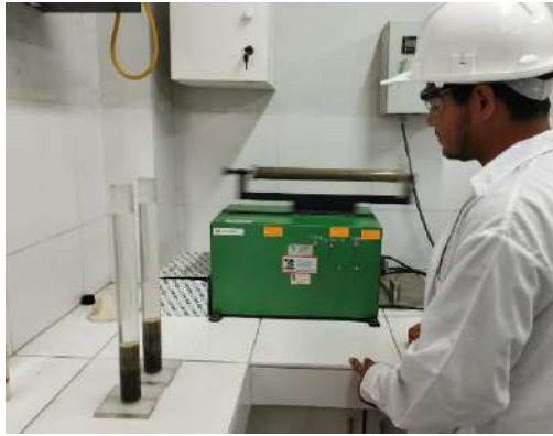
Vista: Equivalente de arena de suelos y agregados finos. NTP 339.146 /ASTM D 2419 /AASHTO T - 104/ MTC E 114
