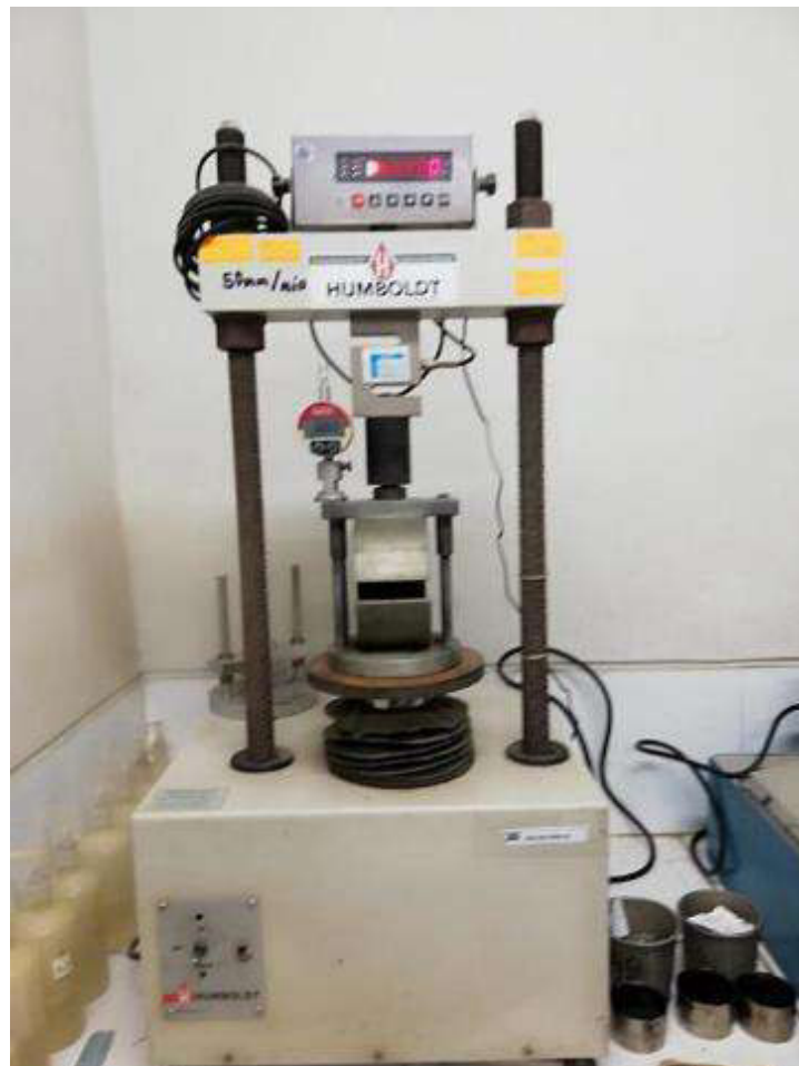
Vista: Ensayo de estabilidad Marshall con PET. Obtenándose el porcentaje óptimo de PET añadido a la mezcla asfáltica es de 0.25%
