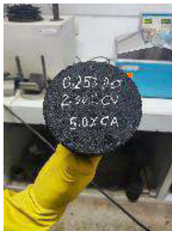
Vista: Briqueta con 0.25% de pet + 2% de cenizas volantes
