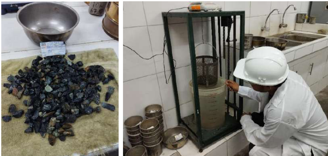
Vista: Gravedad específica y absorción del agregado grueso. NTP 400.021 /ASTM C 535 /AASHTO T -96 /MTC E 206.
