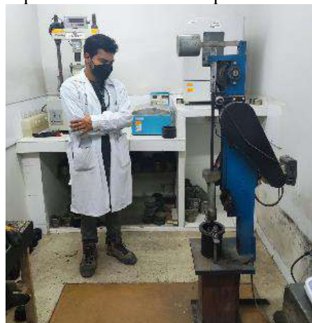
Vista: Compactación de mezcla asfáltica.
