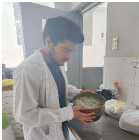
Vista: Análisis granulométrico del PET por tamices
