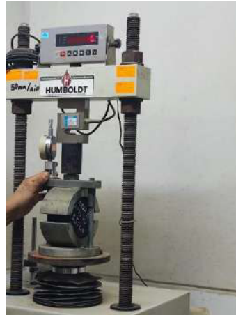
Vista: Estabilidad Marshall 0.25%pet +2%cv y 5.5% de asfalto
