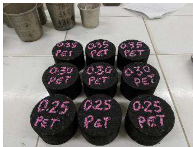
Vista: Briquetas asfálticas con TEREFTALATO DE POLIETILENO (PET) a diferentes porcentajes.
