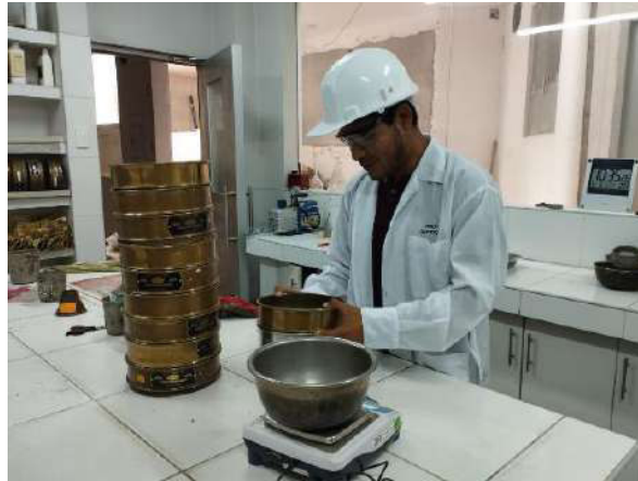
Vista: Análisis Granulométrico De Agregados Gruesos Y Finos MTC E 204 – 2016.
