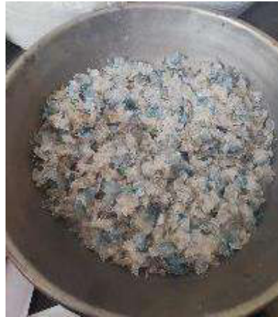
Vista: Muestra de PET triturado (tamaño variable 9.52 mm – 3.6 mm)
