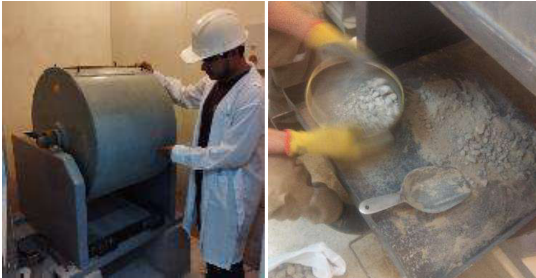
Vista: Ensayo de resistencia a la degradación en agregados gruesos de tamaño grande por abrasión e impacto en la Máquina de los Ángeles. NTP 400.020 / ASTM C 535 / AASHTO T -96 / MTC E 207
