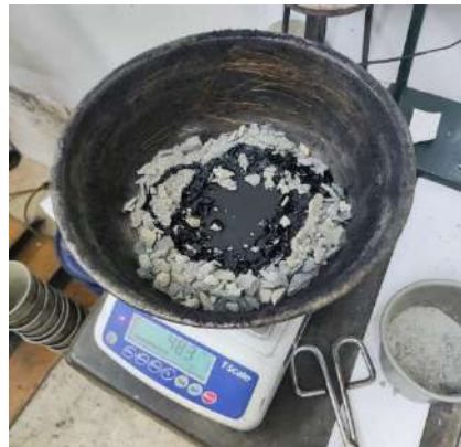
Vista: Verificación de pesos de los agregados y asfalto para la mezcla.
