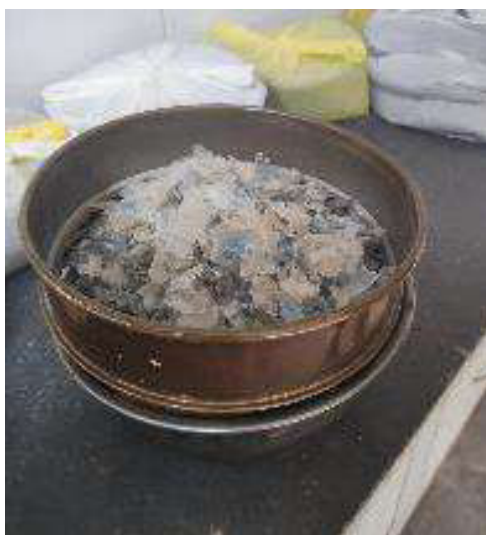
Vista: Muestra de PET triturado pasante la malla 3/8" (9.52 mm – 3.6 mm)
