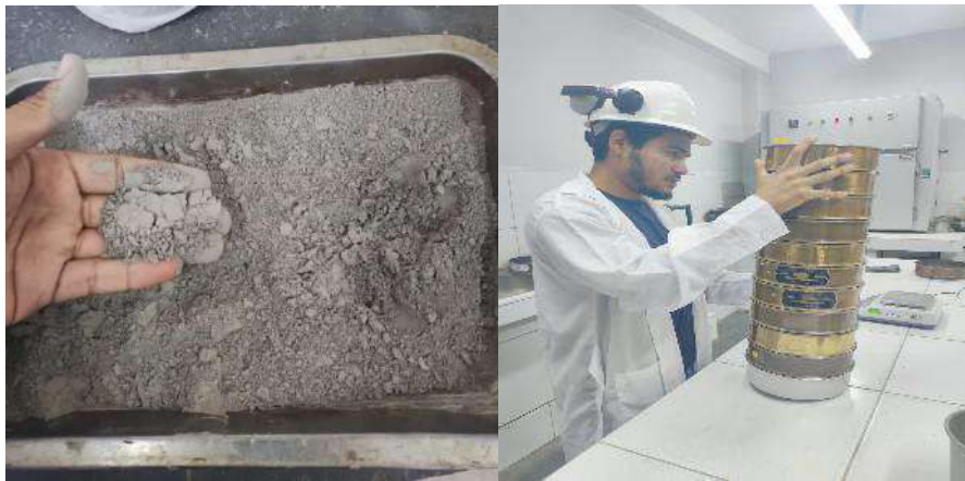
Vista: Ensayo granulométrico a las cenizas volantes por tamices
