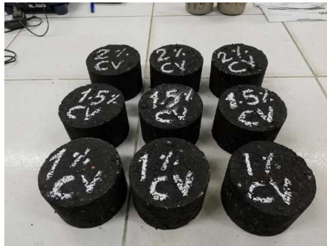
Vista: Elaboración de briquetas de asfalto con cenizas volantes al 1%,1.5% y 2%
