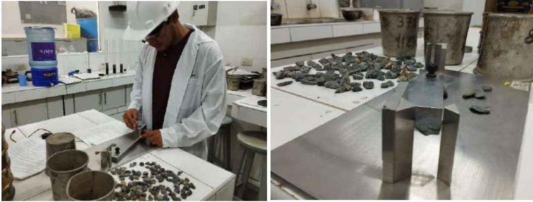
Vista: Partículas chatas y alargadas del agregado grueso. NTP 400.040/ ASTM D 4791/ MTC E 221
