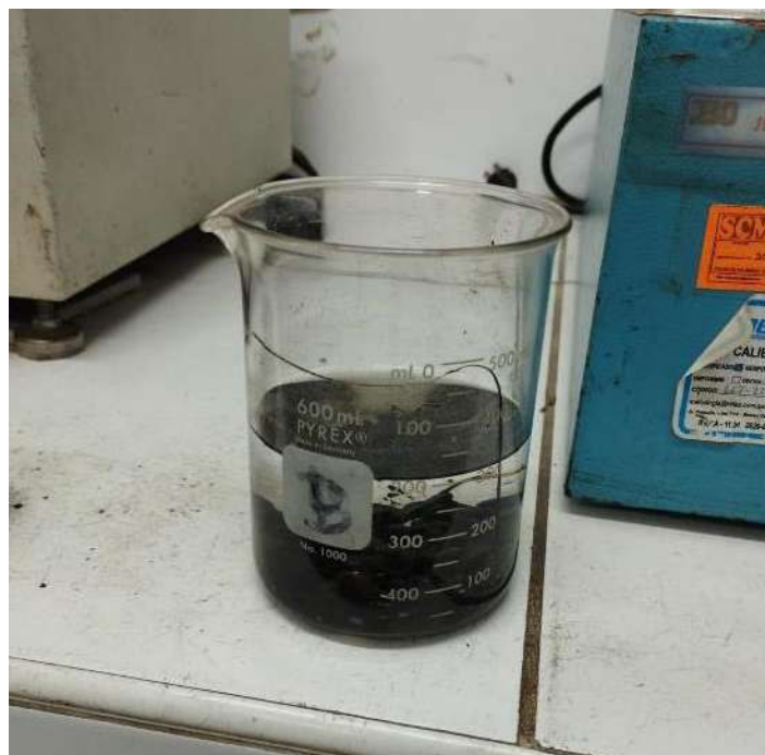
Vista: Ensayo de adherencia agregado grueso - asfalto (Strippin). MTC E 517
