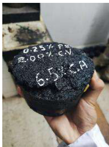
Vista: Briqueta después del ensayo de estabilidad y flujo
