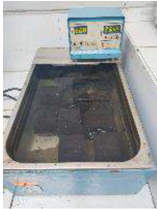
Vista: Colocación de briquetas en baño maría por 30 minutos a 60°C
