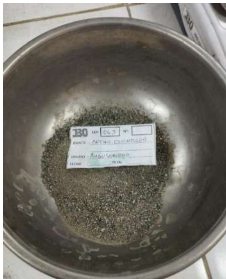
Vista: Angularidad del agregado fino.
