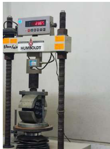
Vista: Estabilidad Marshall 0.25%pet +2%cv y 6% de asfalto
