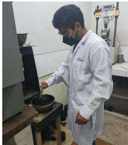
Vista: Proceso de mezcla uniforme de los agregados con el asfalto.
