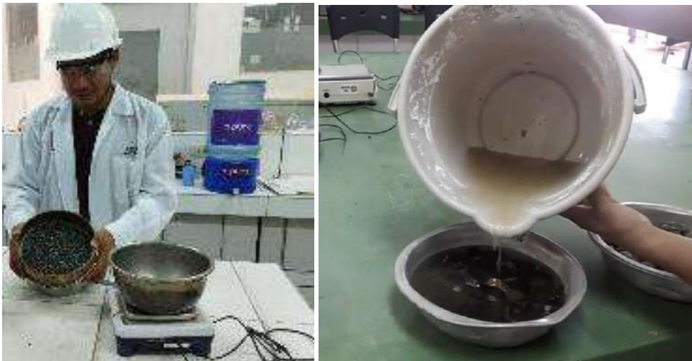
Vista: Inalterabilidad de los agregados por medio del sulfato de sodio o magnesio (Durabilidad), con reactivo químico Sulfato de Magnesio (Grueso). NTP 400.016 /ASTM C 88 /AASHTO T -104 /MTC E 209
