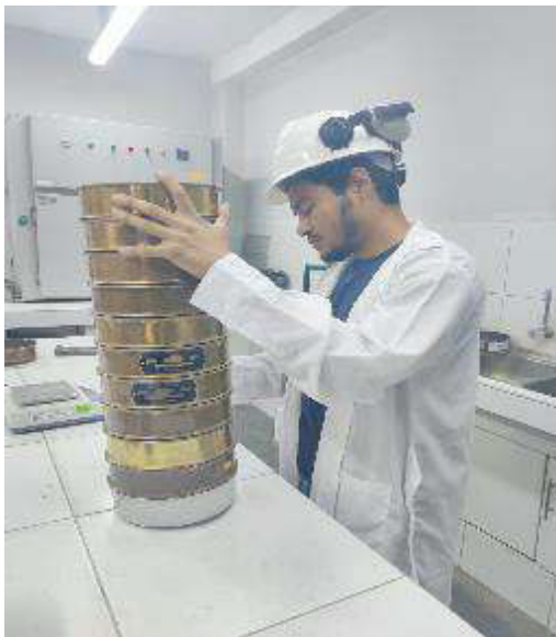
Vista: Análisis granulométrico del PET por tamices
