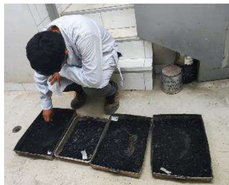
Vista: Preparación de muestra para obtener el Peso Específico Máximo - Rice (ASTM D 2041)
