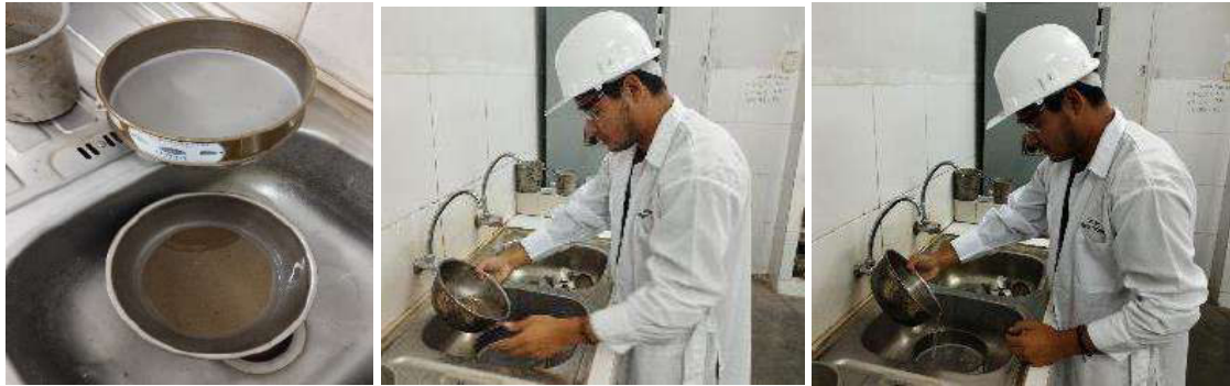
Vista: Ensayo para determinar el índice de plasticidad de suelos - Límite Plástico al material pasante malla N° 200.
