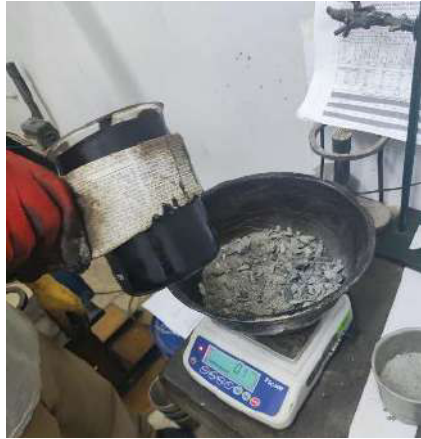
Vista: Adición del asfalto de acuerdo a la proporción correcta.
