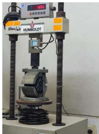
Vista: Estabilidad Marshall 0.25%pet +2%cv y 5% de asfalto
