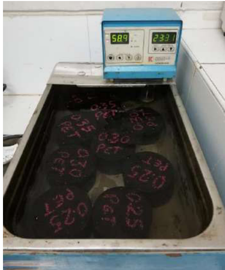
Vista: Colocación en Baño maría a 60°C por 30 minutos antes del ensayo de estabilidad Marshall
