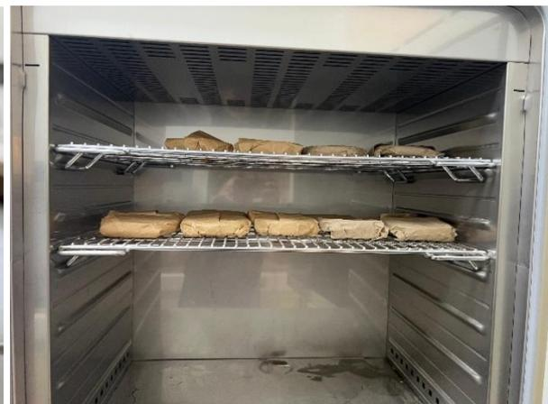
Placas en la incubadora a 37° grados para luego ser retiradas a las 24, 48 y 72 horas y realizar la medición de los halos.
