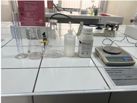
La preparación del Agar Müller Hinton se hizo siguiendo las indicaciones del fabricante (Himedia) donde se suspende 38gr en 1000ml de agua destilada.
