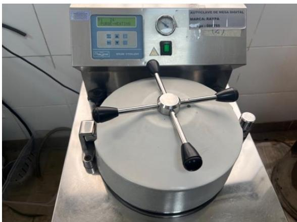
Siguiendo las indicaciones del fabricante se esterilizo en autoclave a una presión de 121° C durante 15min, posteriormente se dejó enfriar, para verter en las placas.
