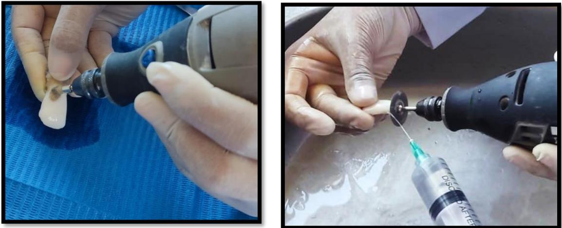
4. Cortes con dimensiones 4x5x2mm preparados para la colocacion en un pvc relleno con acrilico autocurado
