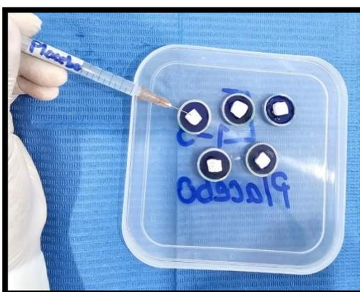
10. Durante los 21 días se hizo el ciclo erosivo-remineralización (proceso de cambio de saliva artificial, agua destilada y ácido cítrico 0.3%)
