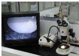
Estéreo microscopio para pruebas de distorsión, blanqueo, agrietamiento y porosidad
