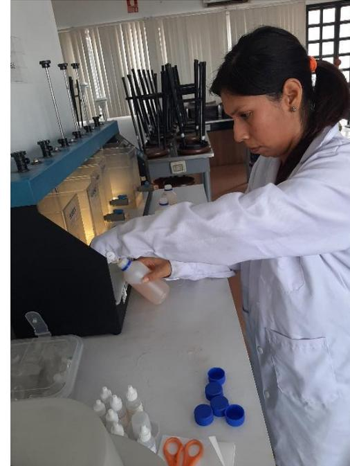
Toma de muestras después del proceso de Floculación de la muestra de agua residual.
