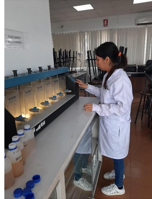
Acondicionamiento de muestras del efluente domestico en las Jarras del Floculador.
