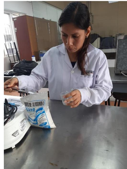
Preparación de soluciones de Sulfato de Aluminio para las dosificaciones correspondientes en el tratamiento
