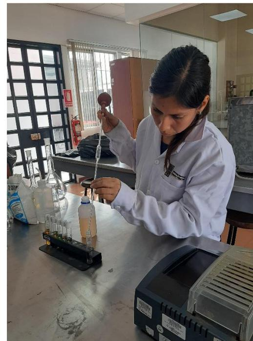
Toma de muestras y adición de reactivos para la determinación de la DQO
