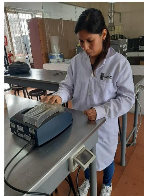
Puesta de viales con las muestras y reactivos en el digestor para la determinación de la DQO
