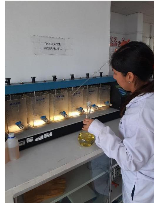
Adición de las dosis del Floculante de Sulfato de Aluminio a las muestras de agua residual
