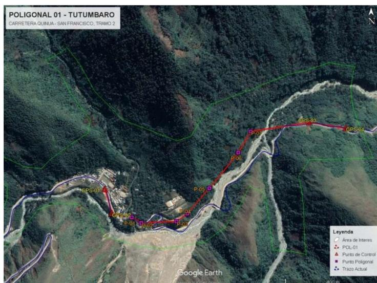
La figura 11, nos deja observar la distribución de los dieciocho (18) puntos de la poligonal de apoyo. Y de los puntos de control de la red secundaria GPS-07, GPS-08, GPS-11 y GPS-12.
