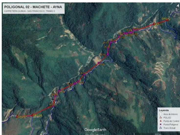
La figura 12, nos deja observar la distribución de los trece (13) puntos de la poligonal de apoyo. y de los puntos de control de la red secundaria GPS-17, GPS-18, GPS-19 y GPS-20.
