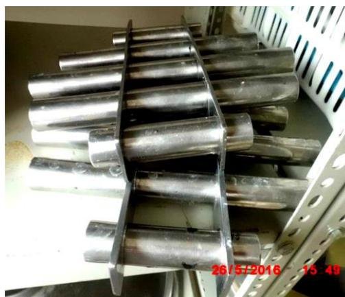
**Fig. 8.** Izquierda: etapa de selección de los hipocótilos de maca, derecha: imán empleado para retener partículas metálicas.
