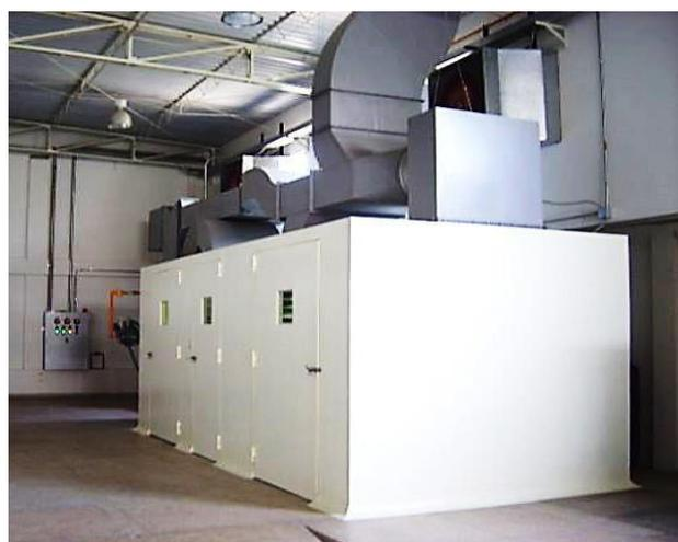
**Fig. 11.** Sistema de cámaras de deshidratación.
