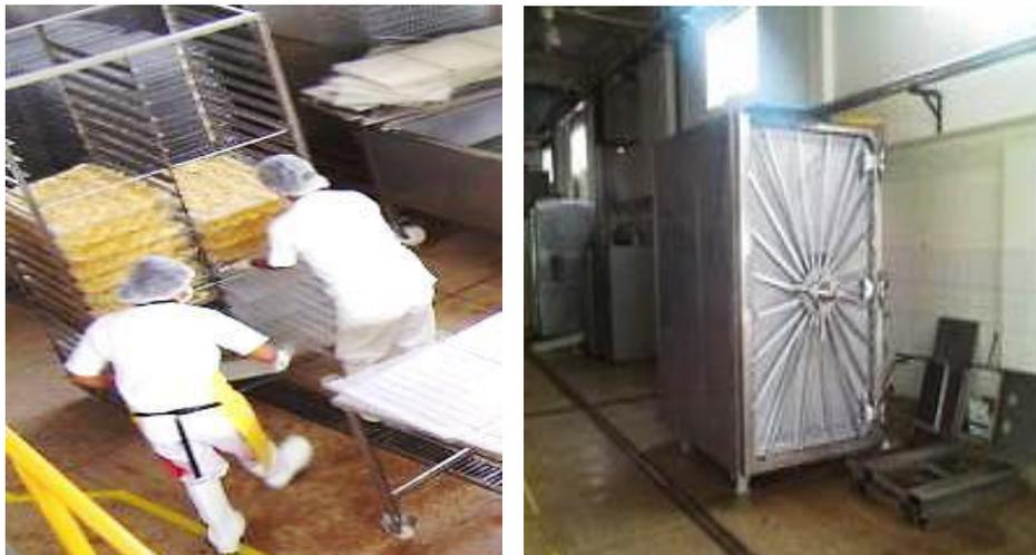
**Fig. 10.** Izquierda: Coches donde con la maca trozada que ingresa al equipo de tratamiento térmico, derecha: equipo de tratamiento térmico “Paul”.
