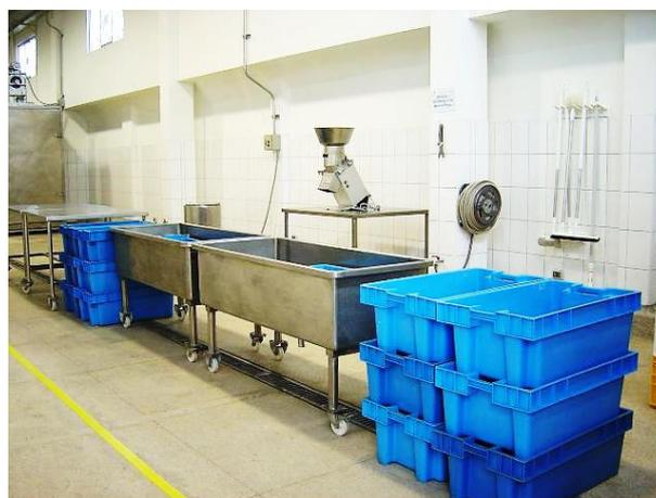
**Fig. 9.** Lavado y desinfección: tinas de acero inoxidable empleadas para el lavado y la preparación de la solución de  $\text{ClO}_2$ , jabas de plástico que contienen la maca.
