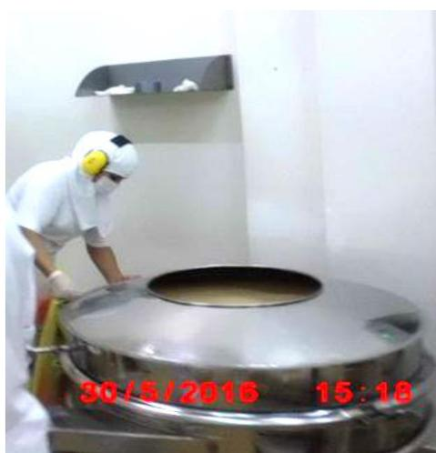
**Fig. 12.** Izquierda: equipo de vibración empleado para el tamizaje de la maca en polvo.
