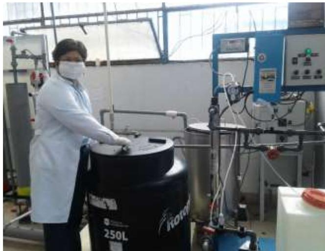
Foto 2. Tanque de almacenamiento del Sistema de tratamiento POA
