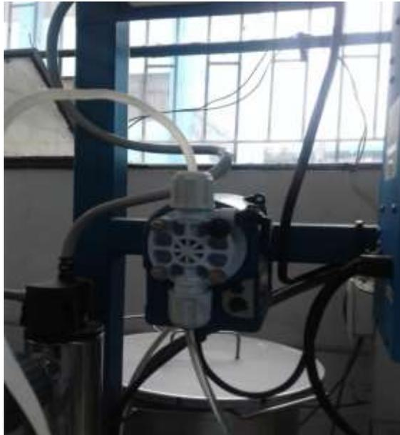
Foto 6 Equipo de inyección de Peróxido de hidrogeno
