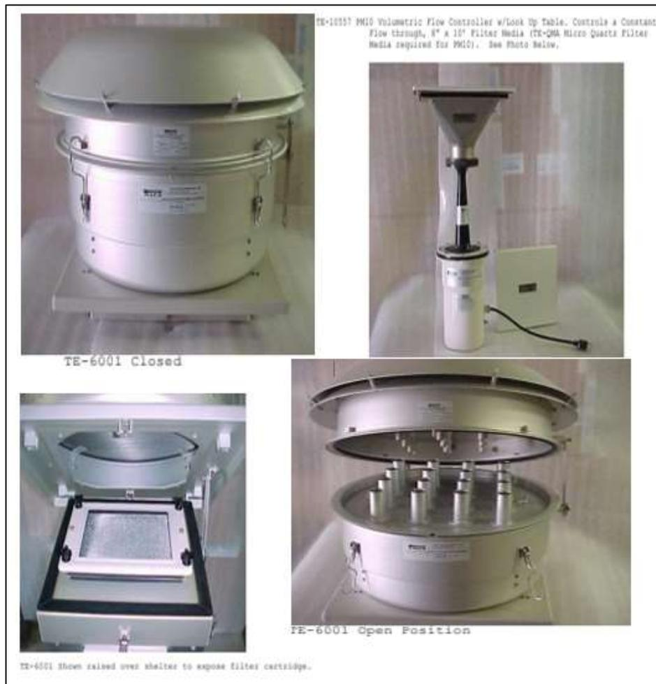
*Figura 4.* Equipo alto volumen para monitoreo de calidad de aire PM-10
