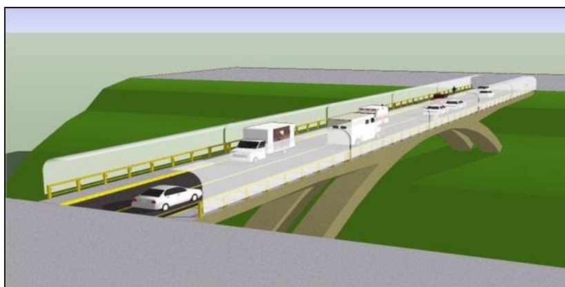
Figura 2. Diseño de puente tipo arco de concreto armado.
