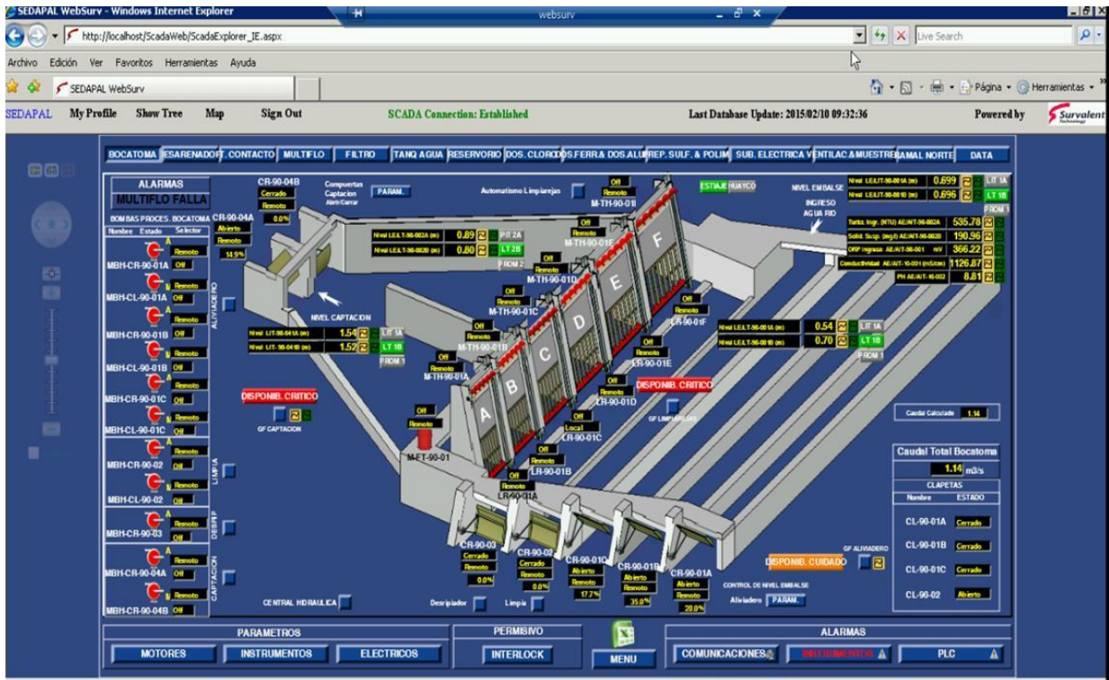
Figura 74 Visualización del sistema SCADA en la Web
