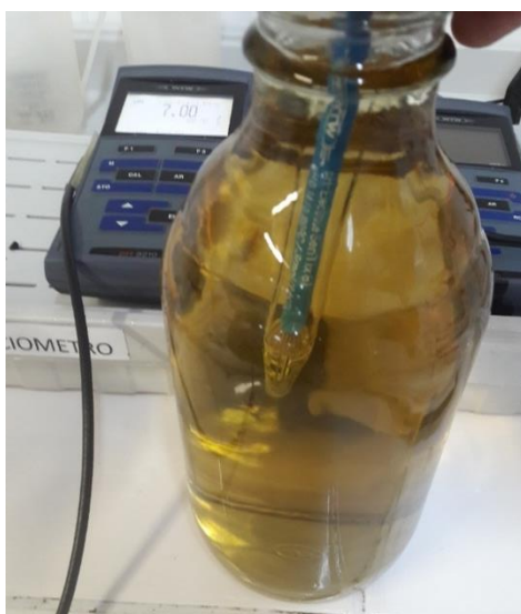
Figura 2.- Medición del valor de pH de la preparación de agua peptonada bufferada. Según indicaciones del fabricante el pH que se debe obtener debe de ser 7.0 +/- 0.2 pH.
