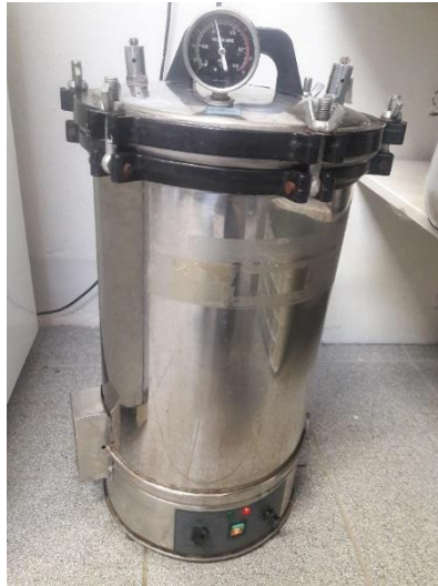
Figura 3.- Autoclave vertical marca Kyndel modelo XSF 280 MB+, durante el proceso de esterilizado se observa que el indicador de temperatura marcó 121°C.
