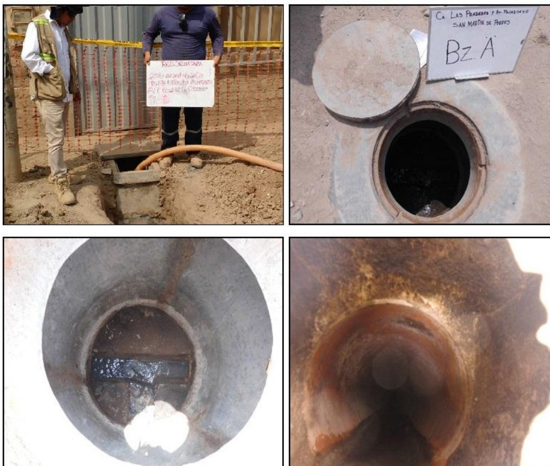
Figura 36: Prueba hidráulica de conexiones para verificar cálculos /Aforos en el Buzón BE-A
